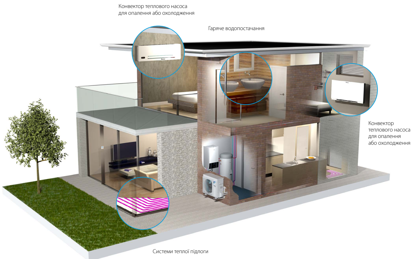
Приклад установки з баком ГВП з нержавіючої сталі (EKHWS(P)-D).
