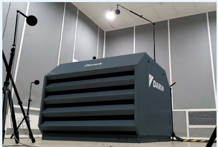
Вимірювання рівня звукової потужності в акустичній камері
