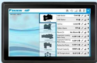
Панель оператора з сенсорним екраном інтуїтивно зрозуміла і проста у використанні для підвищення продуктивності роботи оператора. Важлива інформація про стан та керування доступна з одного погляду або натискання.
