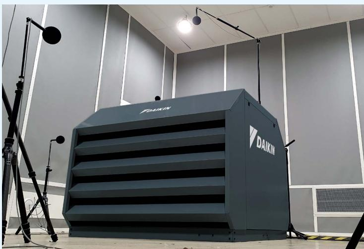
Вимірювання рівня звукової потужності в акустичній камері
