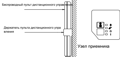
Монтаж на поверхности стены
