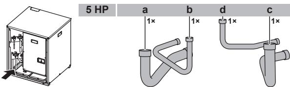
a+b Принадлежности для прокладки трубопровода контура 1 (к теплообменнику)
