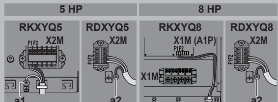
a1, a2 Заземление (пользуйтесь винтом, входящим в комплект принадлежностей)
