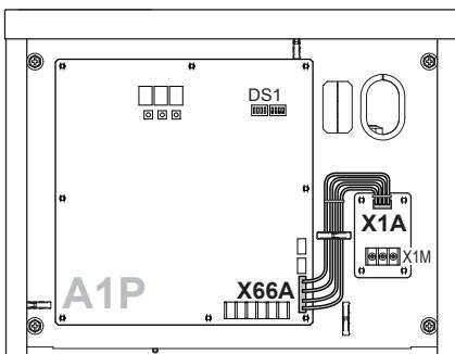
6 Подключите переключатель режимов охлаждения-обогрева. Момент затяжки X1M (A/B/C): 0,53~0,63 Н·м
