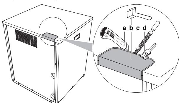
а Срежьте изоляцию (под выбивным отверстием).
