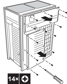
После того, как передние панели будут открыты, можно получить доступ к блоку электрических компонентов. См. раздел «6.2.2 Как открыть блок электрических компонентов наружного блока» на стр. 25.
