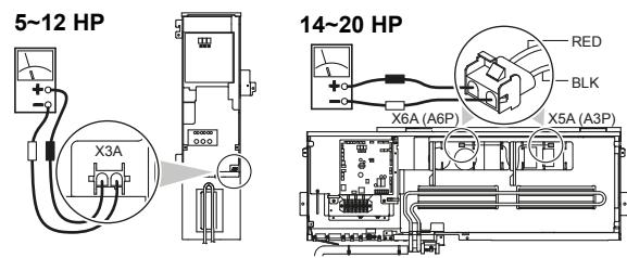
3 Прежде чем приступить к обслуживанию инверторного оборудования, разъедините соединительные разъемы X1A, X2A электромоторов вентиляторов наружного блока. Не дотрагивайтесь до деталей, находящихся под напряжением. (Если под действием сильного ветра вентилятор будет вращаться, он может подавать электричество в конденсатор или основную цепь, что приведет к поражению электрическим током).
