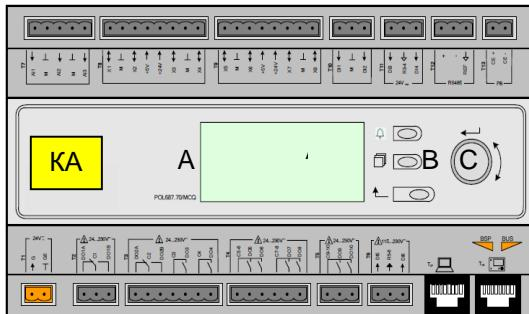
Клавишная панель/дисплей (A) включает в себя 5-строчный дисплей на 22 символа. Ниже указаны функции трех кнопок (B):
