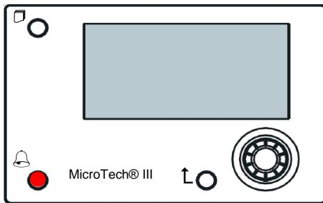
Длину кабеля ЧМИ удаленного пользователя можно увеличить до 700 м, используя подключение через технологическую шину на контроллере агрегата. По гирляндной схеме, показанной ниже, один ЧМИ может быть подключен к максимум 8 агрегатам. Подробную информацию см. в отдельном руководстве по ЧМИ.
