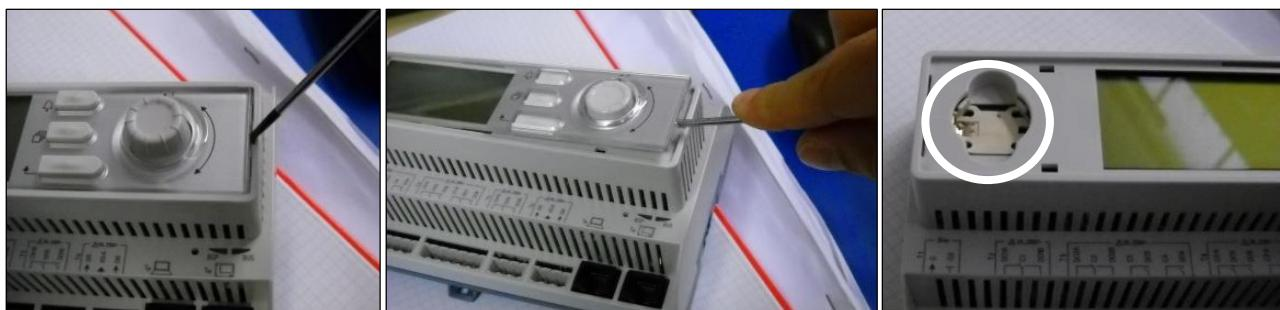
Не повредите пластмассовую крышку. Новая батарея устанавливается в соответствующий отсек (см. обозначение на рисунке) с соблюдением полярности.
